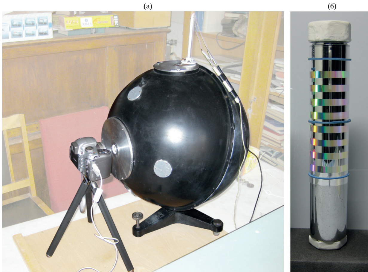
Рис. 1. а – установка на основе фотометрической камеры № 3, б – внешний вид дифракционного оптического элемента.
